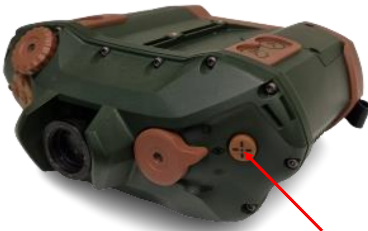
Abbildung 21: Knopf auf dem MOSKITO TI, um eine Messung zu starten
